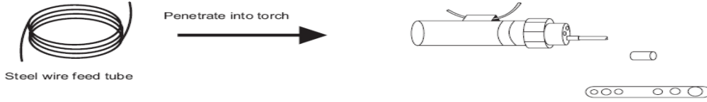
Şekil 4-7-5- Teflon tel borusu montaj kılavuzu
